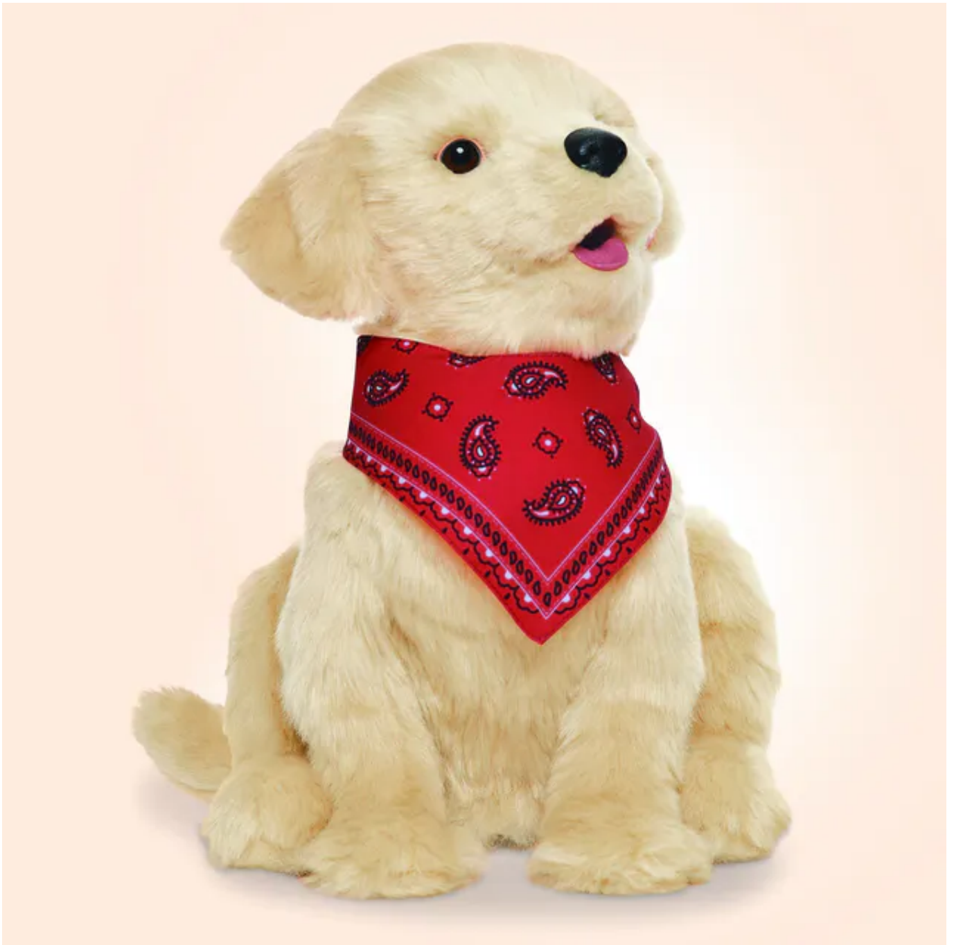
Deze interactieve robohond van Joy for All is bedoeld voor dementerende ouderen: aaibaar, en reagerend op aanraking en geluid. Illustratie: Ageless Innovations
